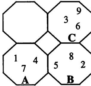
Fig. 2.10: Cell Reuse Scheme
