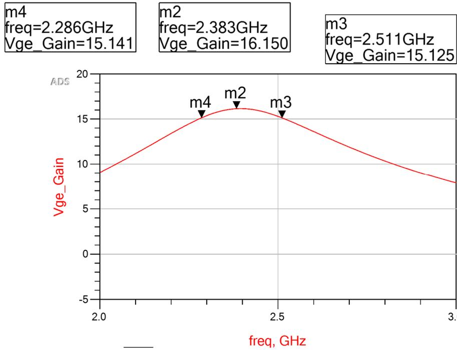
Figure 12: LNA voltage gain
