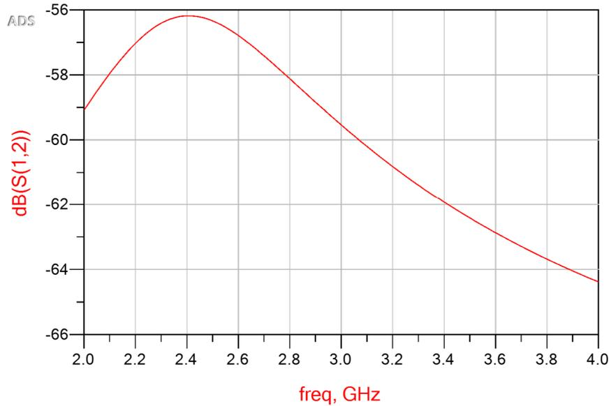
Figure 14: LNA reverse isolation
