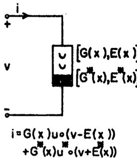
(d) x-controlled bi-convex resistor
