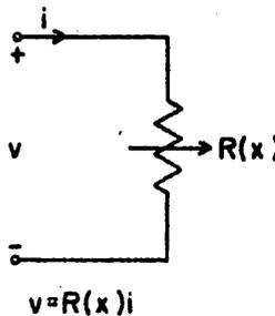
(d) x-controlled linear conductor
