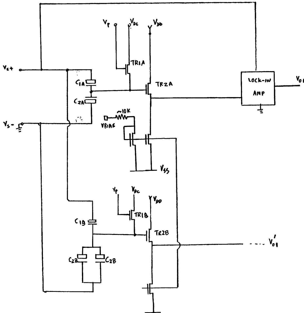
FIG 5.3 TEST CHIP AND TESTSET UP (ONLY ONE LOCK-IN AMP CONNECTION SHOWN)
