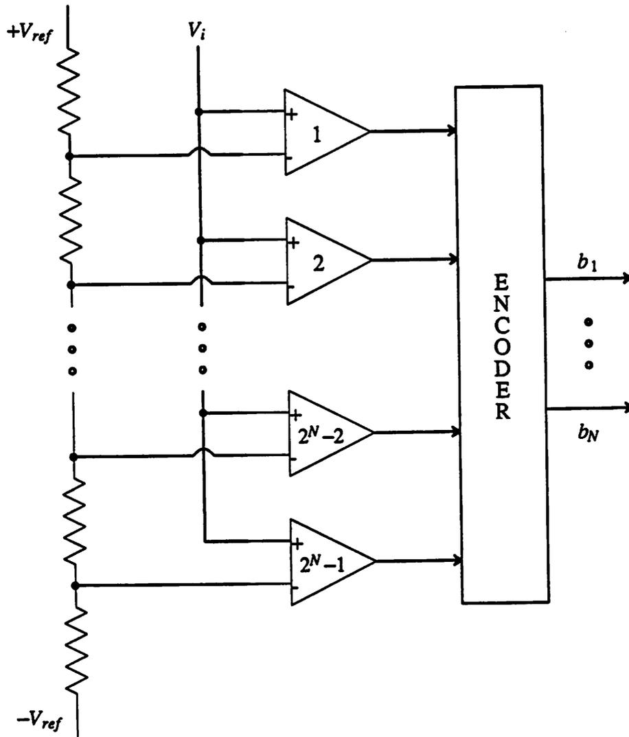
Fig. 3.1 Flash A/D Converter
