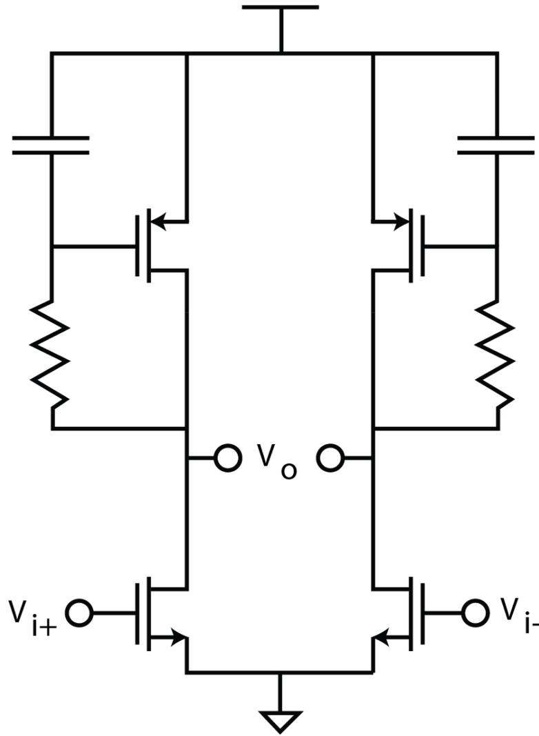
Figure 3.14: IF LNA schematic
