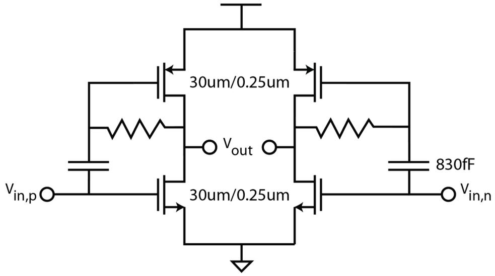
Figure 4.7: IF LNA schematic diagram
